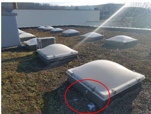
Abbildung 3 Knoten, die auf der nordwärts gerichteten Seite des Oberlichts platziert sind, um eine direkte Sonnenbestrahlung zu vermeiden.
