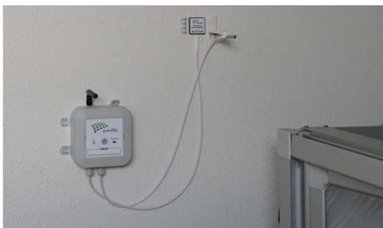
**Abb. 4:** gOMS-Sensoren zur Messung von Wärmefluss, Oberflächen- und Raumlufttemperatur an der Innenwand von Büro B5
